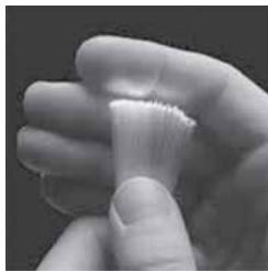
تارهای نوری که نور از نوک آن‌ها خارج می‌شود و در بدنه‌ی آن‌ها بازتاب کلی رخ می‌دهد.
