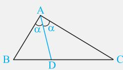
۱ نیمساز خطی است که از رأس زاویه می‌گذرد و زاویه را به دو قسمت مساوی تقسیم می‌کند. هر نقطه روی نیمساز از دو ضلع زاویه به یک فاصله است.
