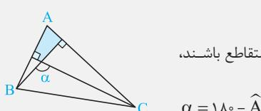
زاویه‌ی بین دو ارتفاع خارج شده از رأس‌های  $B$  و  $C$  (وارد بر اضلاع  $b$  و  $c$ ) که در درون مثلث متقطع باشند، برابر است با:
